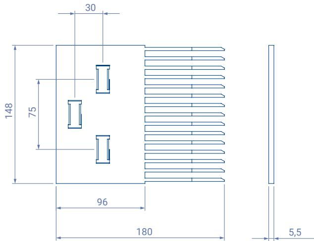
Les peignes de transfert ont été dessinés pour être utilisés avec la surface Raised Rib dans des applications de jonction de lignes où il est nécessaire de réaliser le transfert du produit.
