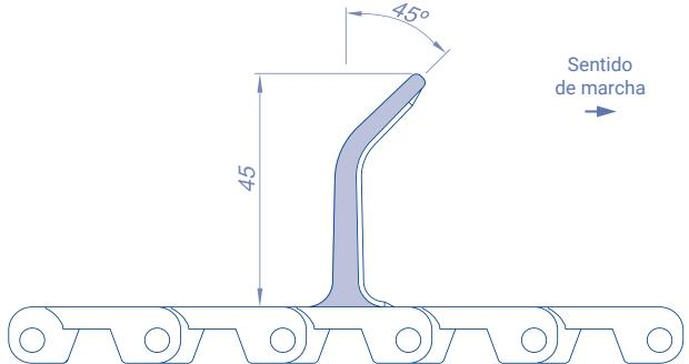
Des tasseaux courbes sont disponibles pour les applications où il est nécessaire d'utiliser la capacité maximale du tasseau sur des pentes raides.
